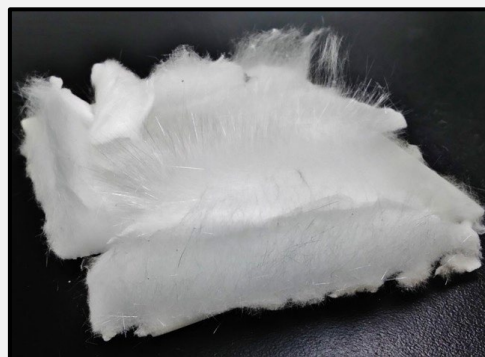
Thermalnite ® (ファイバー状窒化アルミニウム単結晶)
