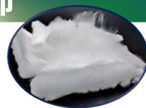
Thermalnite® 「サーマルナイト」 (ファイバー状窒化アルミニウム単結晶)
